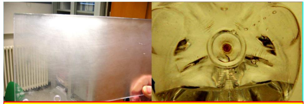
I tensioattivi nonionici (antischiuma, detergenti) sono tra i principali artefici di opacità (hazing) e depolimerizzazione (stresscracking)
